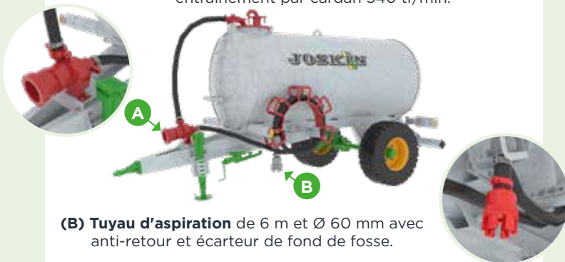
(A) Pompe centrifuge de remplissage : débit 1 000 l/min, entraînement par cardan 540 tr/min.
